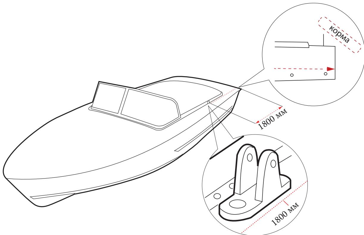
1. Установите кронштейн крепления дуг к корпусу лодки, на расстоянии 1800 мм (по центру кронштейна) от корпуса лодки с задней стороны (см. рис)
